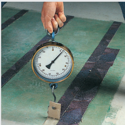
Probeverklebung und Prüfung des Schälwiderstands
