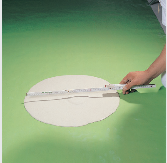
Fließmaß einhalten. Der Estrich darf bei der Verarbeitung kein Wasser abstoßen
