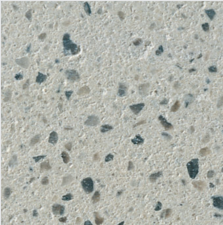
Querschnitt Knauf Fließestrich, 4-fach vergrößert
