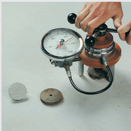
Prüfung der Haftzugfestigkeit
