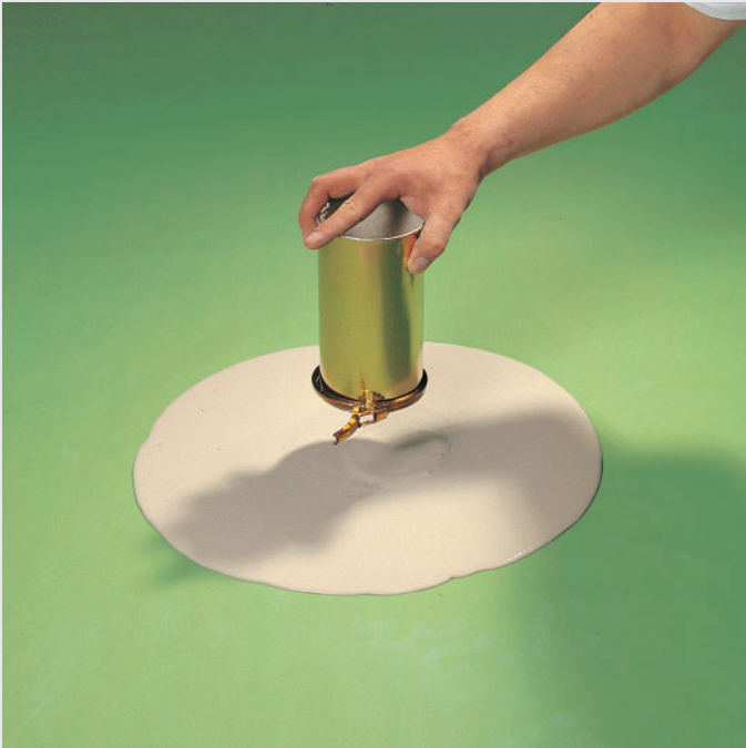
Bestimmung des Fließmaßes: Fließmaßdose mit Mörtel füllen und hochziehen
